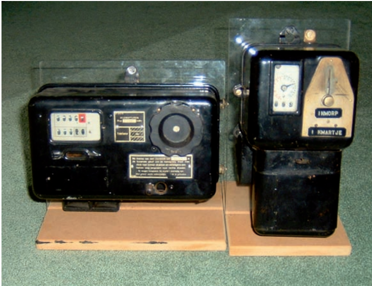
Muntmeters voor gas en elektra (ill. Quistnix op de Nederlandstalige Wikipedia, CC BY 1.0 nl)
